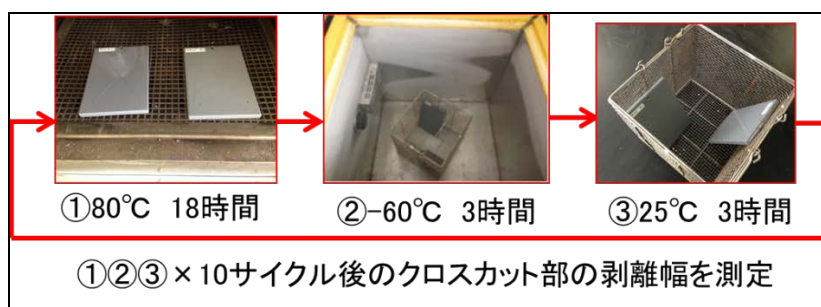
図2 冷熱サイクル試験方法 (JIS K5600-7-4 準拠)
