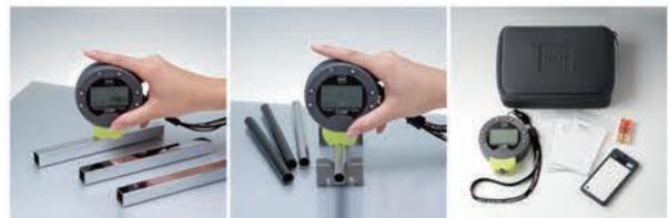
●角棒の測定例 ●丸棒の測定例 ●キャリング・ポーチと付属品
