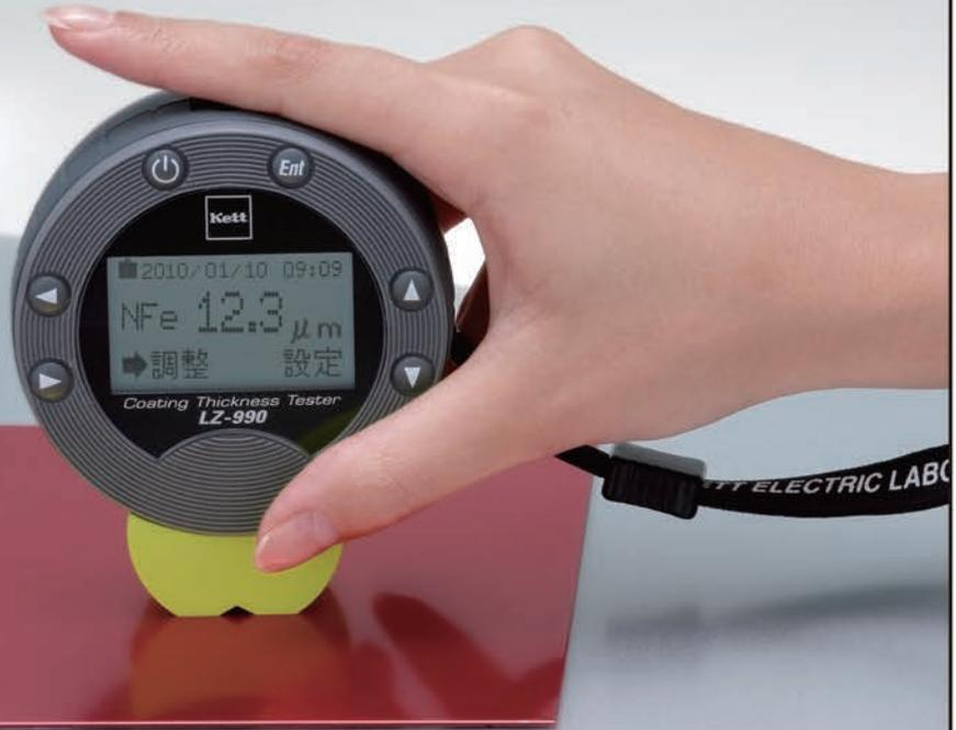
デュアルタイプ膜厚計 LZ-990「エスカル」は必要最低限の操作キーだけを備えた膜厚計です。シンプルながら膜厚管理に必要な機能は充実し、アプリケーション(検量線)メモリ、測定データメモリ、膜厚管理の上下限設定、統計処理、データ出力などの15種の機能を装備しています。1台で鉄や鋼などの磁性体金属に施されたペイント厚やメッキ厚等の測定と、アルミや銅などの非磁性体金属に施されたペイント厚やアルマイト被膜厚等の測定が可能です。しかも、素材を自動判別しその測定モードへ切り替わります。プリンタや測定スタンド、外部出力ケーブルなどのオプションも充実しています。
