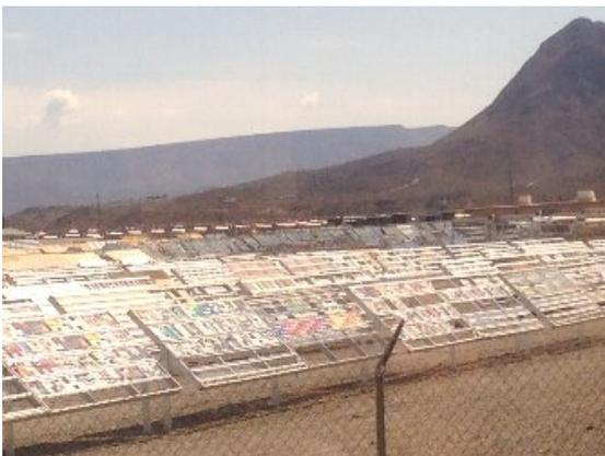
写真 4.3 直接暴露試験(アリゾナ暴露場)
