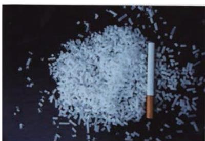
写真1 直径3mmのドライアイスペレット
