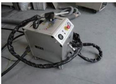
写真2 ドライアイスブラスト機
