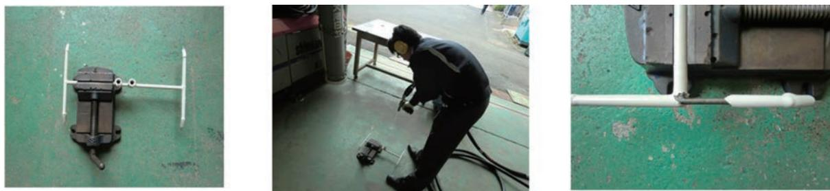
写真7 塗装治具の塗膜剥離
