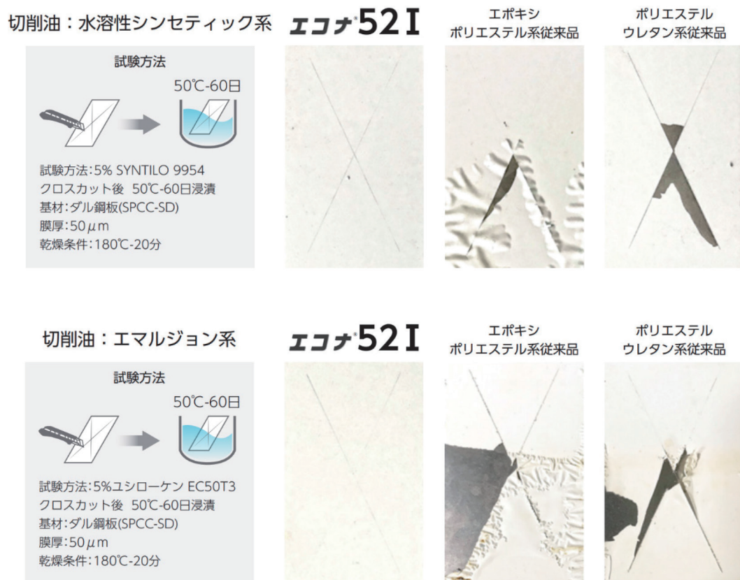
図5 耐切削油性の試験結果
