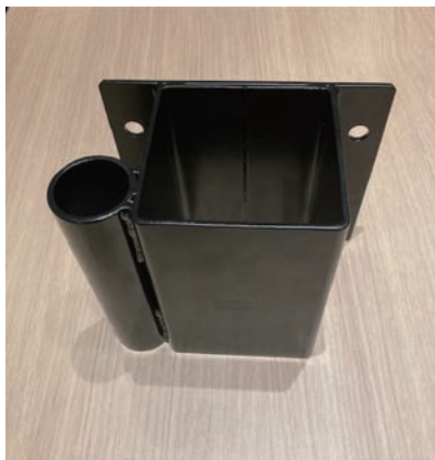
写真2 (ヒーターの照射は外側からのみで行ったが、内面も乾燥・硬化が成されている) ワーク材質: 鉄製/板厚: 3 mm/塗料: エポキシ粉体塗料
