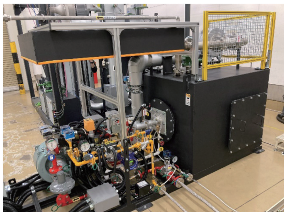
図9 熱風発生装置外観（46 kW）
