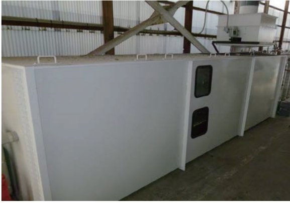
図3 現在の VOC 処理槽
