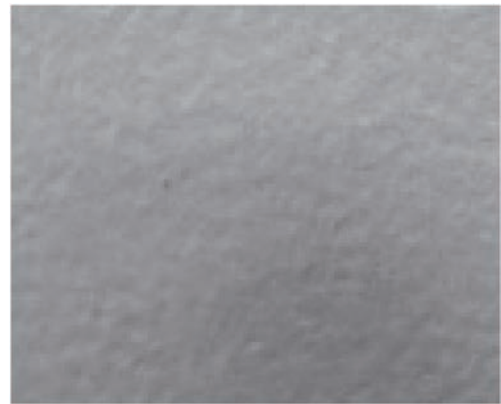
図7 逆電離（静電反発）による塗装不良例
