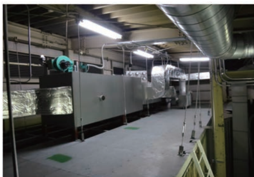
写真 1 乾燥炉排ガス処理・熱回収システム取付け部
