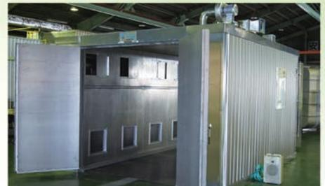
PWT搭載 新規バッチ炉
