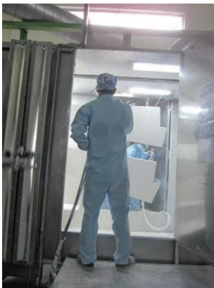
写真4 サクセス社・粉体レシプロ+ハンドガン補正
