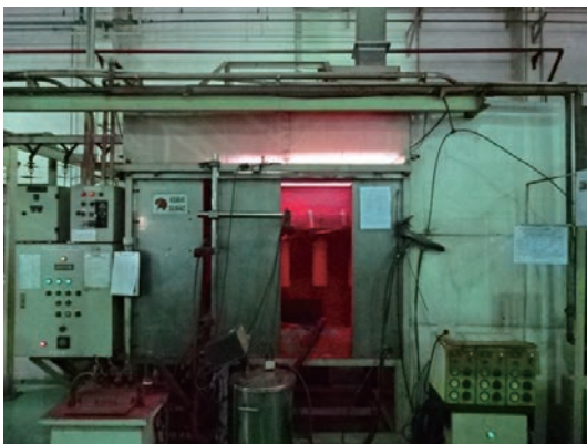
写真8 ヤマトプロテック・外面は上・中・底部を3ガンで塗装
