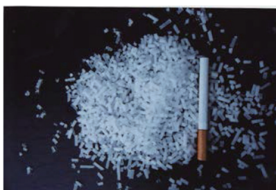
写真1 直径3mmのドライアイスペレット
