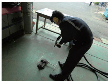
写真7 塗装治具の塗膜剥離
