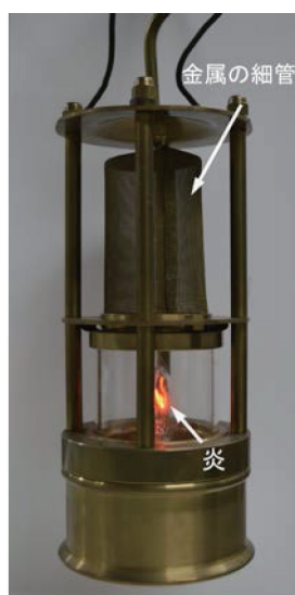
写真1 坑内用安全ランプ（模型）
