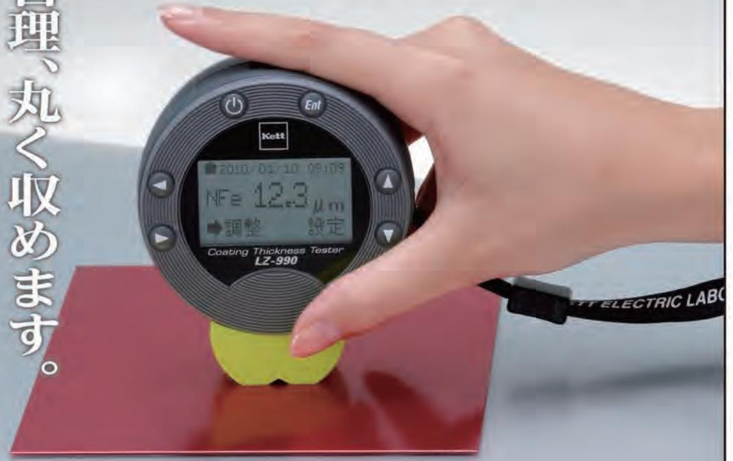
デュアルタイプ膜厚計 LZ-990「エスカル」は必要最低限の操作キーだけを備えた膜厚計です。シンプルながら膜厚管理に必要な機能は充実し、アプリケーション(検量線)メモリ、測定データメモリ、膜厚管理の上下限設定、統計処理、データ出力などの15種の機能を装備しています。1台で鉄や鋼などの磁性体金属に施されたペイント厚やメッキ厚等の測定と、アルミや銅などの非磁性体金属に施されたペイント厚やアルマイト被膜厚等の測定が可能です。しかも、素材を自動判別しその測定モードへ切り替わります。プリンタや測定スタンド、外部出力ケーブルなどのオプションも充実しています。
