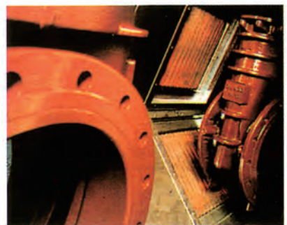
バルブ粉体塗装焼付 160kg、処理時間 15分
