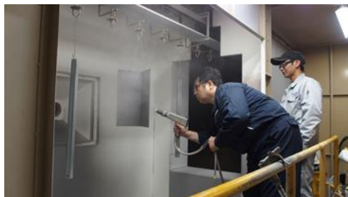
IPD 微粒化粉体塗装制御システムの塗装テスト風景 (塗装者は㈱マルシン後藤専務)
