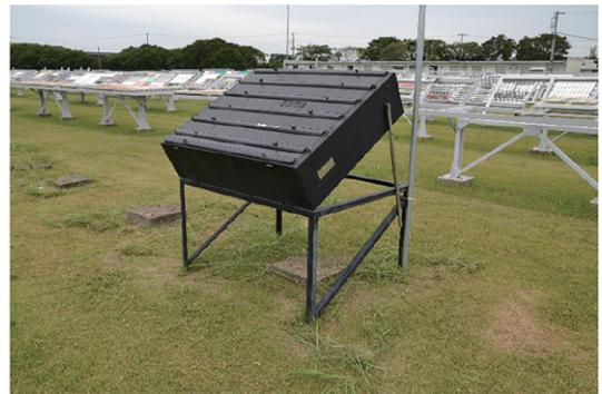
写真8 ブラックボックス暴露試験
