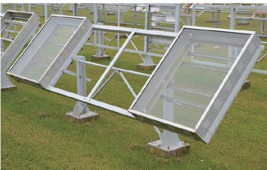
写真6 ガラス越し暴露試験
