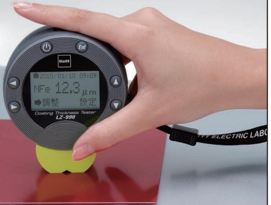
デュアルタイプ膜厚計 LZ-990「エスカル」は必要最低限の操作キーだけを備えた膜厚計です。シンプルながら膜厚管理に必要な機能は充実し、アプリケーション(検量線)メモリ、測定データメモリ、膜厚管理の上下限設定、統計処理、データ出力などの15種の機能を装備しています。1台で鉄や鋼などの磁性体金属に施されたペイント厚やメッキ厚等の測定と、アルミや銅などの非磁性体金属に施されたペイント厚やアルマイト被膜厚等の測定が可能です。しかも、素材を自動判別しその測定モードへ切り替わります。プリンタや測定スタンド、外部出力ケーブルなどのオプションも充実しています。
