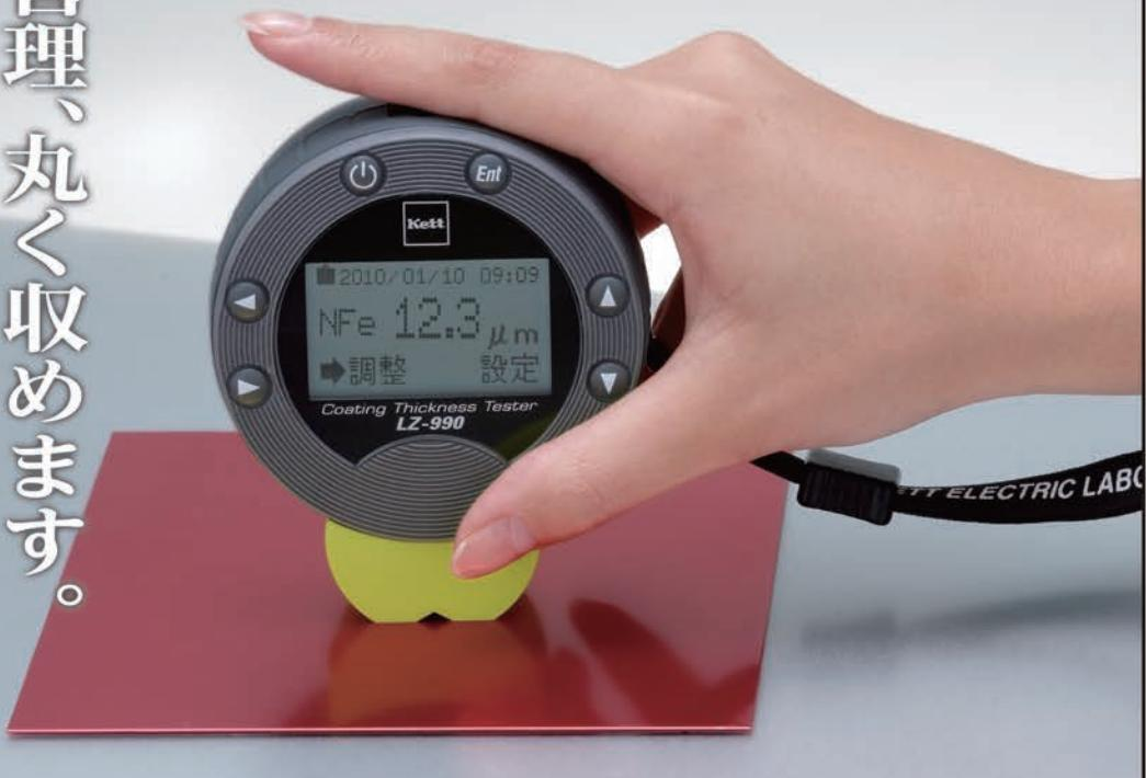
デュアルタイプ膜厚計 LZ-990「エスカル」は必要最低限の操作キーだけを備えた膜厚計です。シンプルながら膜厚管理に必要な機能は充実し、アプリケーション(検量線)メモリ、測定データメモリ、膜厚管理の上下限設定、統計処理、データ出力などの15種の機能を装備しています。
