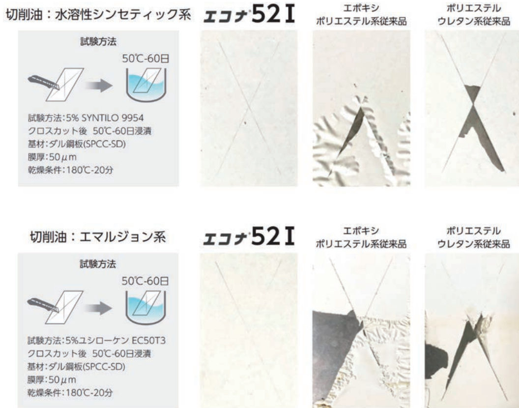
図5 耐切削油性の試験結果
