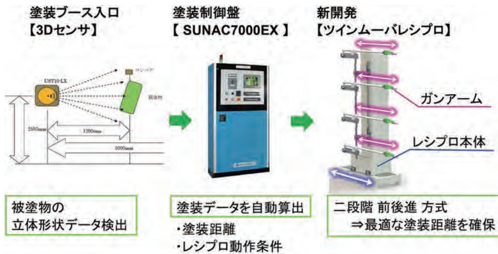
図11 D形状認識自動塗装システムの主要な構成機器
