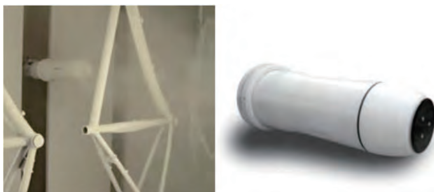
図2 回転式粉体塗装機器イノベル
