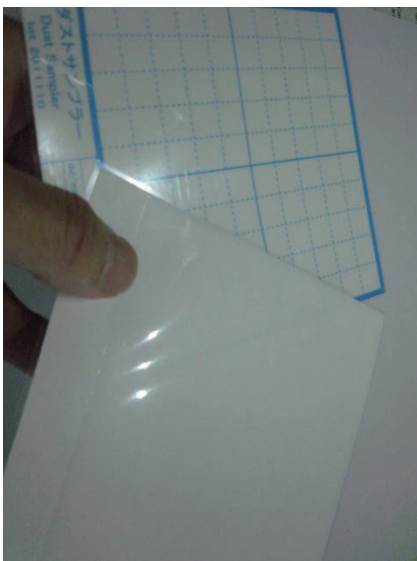
写真7 ダストサンプラーの保護フィルム
