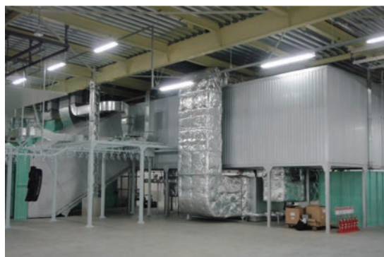
図2 山型乾燥炉
