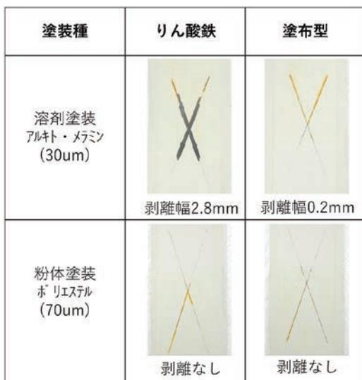
図6 耐食性評価 (3%NaCl 常温、100 h) <sup>(4)</sup>
