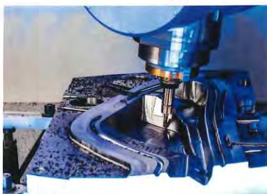
② 加工イメージ 同時5軸加工にて複雑な加工も短時間・高精度で可能とします。
