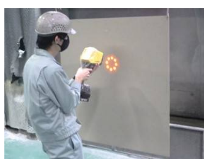
非接触膜厚計による測定（焼付前）
