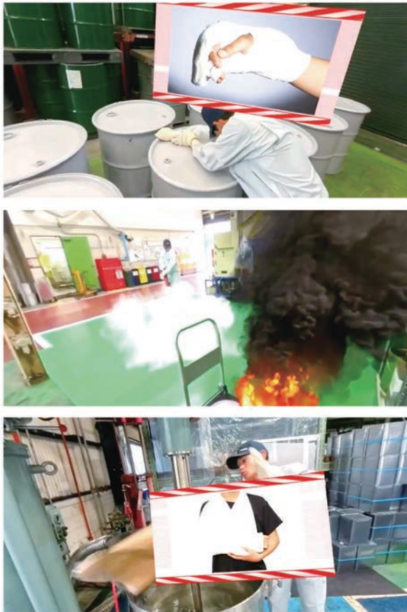
図3 日塗工が開発した労働安全 VR コンテンツ 上 ドラム缶取扱作業における指挟み 中 溶剤小出し作業における静電気火災 下 塗料仕込み時における攪拌機巻き込まれ
