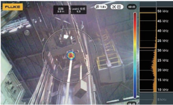
図2 高所配管からのエア漏れを検知
