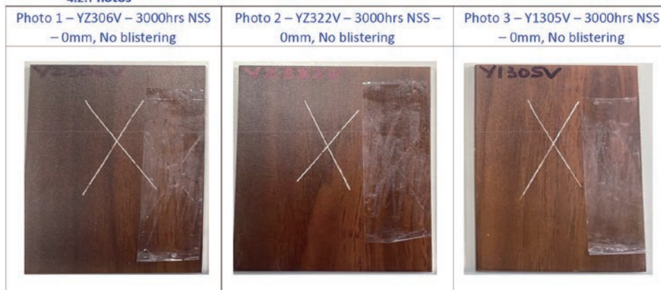
写真1 3,000時間塩水噴霧試験の結果
