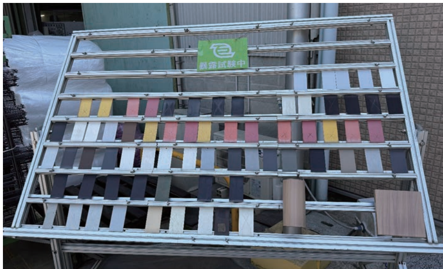
写真7 戸崎産業での屋外暴露試験 6ヶ月経過異常なし (右下2点)
