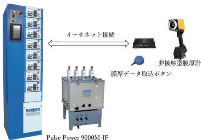
図2 膜厚自動調整システムの機器構成
